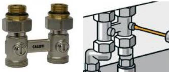
Der Schlitz in den Schrauben, wie oben zu sehen parallel zur Fließrichtung sein. Dann sind die Leitungen geöffnet. Wenn dagegen ein oder beide Schlitz quer zur Fließrichtung sind, dann kann kein Heizungswasser fließen. Die Schrauben mit einem Schraubenzieher um 90° nach links drehen. Dann sollte der Heizkörper gehen.
