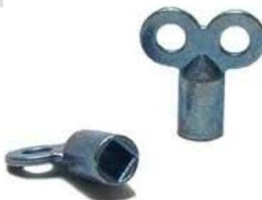
Man öffnet mit einem Schlüssel die Vierkant-Entlüftungsschraube. Manchmal hat der Vierkant auch einen Schlitz, dann reicht auch ein Schraubenzieher. Zuvor die Auslauföffnung nach unten drehen (das kleine weiße Teil lässt sich drehen). Normalerweise hört man anfangs Luft, solange bis Wasser kommt. Dann sofort zudrehen (Es macht technisch gesehen kein Sinn, viel Wasser ablaufen zu lassen!).
